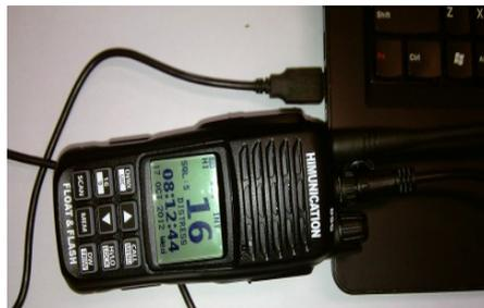
Pour mettre l'appareil en charge, dévissez le capuchon de protection du connecteur d'alimentation et de mise à jour logicielle. Connectez ensuite le terminal de broches du câble à l'appareil et le terminal USB du câble au chargeur choisi parmi les deux options possibles (chargeur standard ou prise allume cigare).
