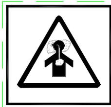
**Il monossido di carbonio può provocare forti nausea, svenimenti, o la morte. Non utilizzare tubature in rame all'interno di impianti di scarico diesel. Lo zolfo presente negli scarichi diesel provoca un deterioramento dell'impianto, portando a perdite dei gas di scarico o di acqua.**
